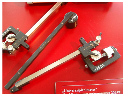
Abbildung 1: Schematischer Aufbau eines Planimeters
