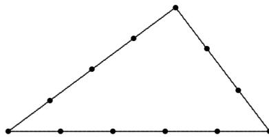
In eine Seilschleife sind 12 Kugeln in gleichem Abstand eingeknüpft. Wird das Seil zu einem Dreieck mit 3, 4 und 5 Abschnitten gespannt, so ergibt sich ein rechter Winkel.
