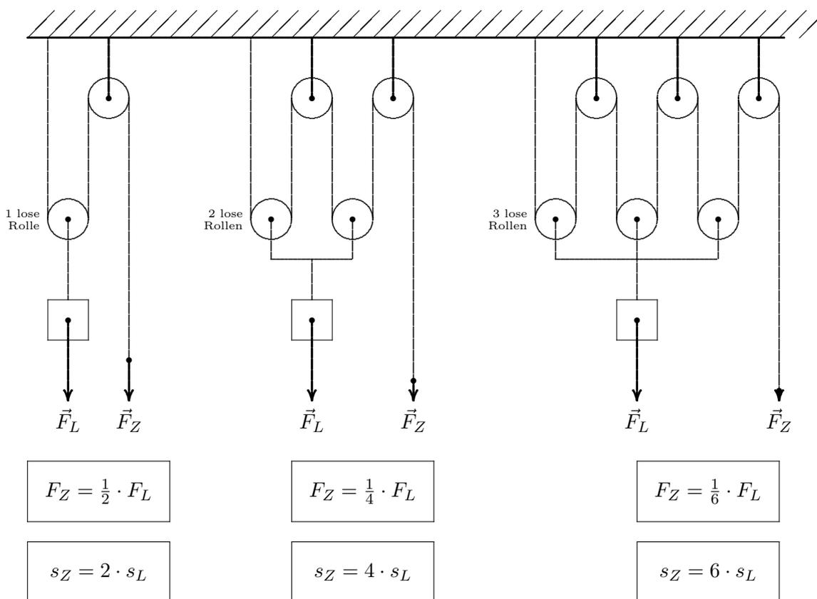
Beim *Produktflaschenzug* sind  $n$  lose Rollen durch einen einfachen Steg miteinander verbunden. Für den Zusammenhang zwischen den Kräften bzw. Seillängen auf Last- und Zugseite gilt allgemein:
