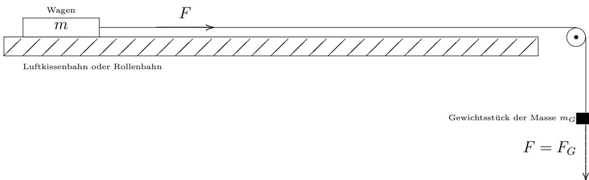
□ Ein Wagen, der sich (möglichst reibungsfrei) auf einer Fahrbahn bewegen kann, wird durch ein Gewichtsstück (Schnur über Umlenkrolle) beschleunigt. Es wird der Zusammenhang zwischen
