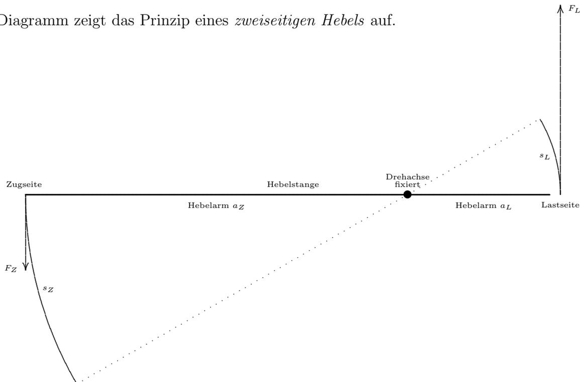
Gemäß Hebelgesetz (Abschnitt 5.1) besteht — bei Reibungsfreiheit der Hebelrotation — eine Gleichheit der Drehmomente („Kraft mal Kraftarm“)
