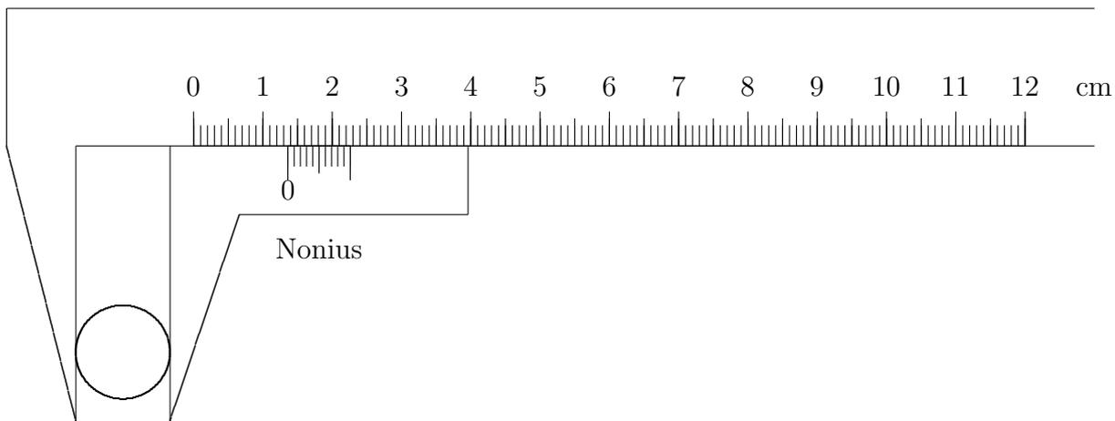
Die Nonius-Skala mit 10 Längenintervallen ist 9 mm lang. Ein Intervall hat die Länge 0,9 mm.
