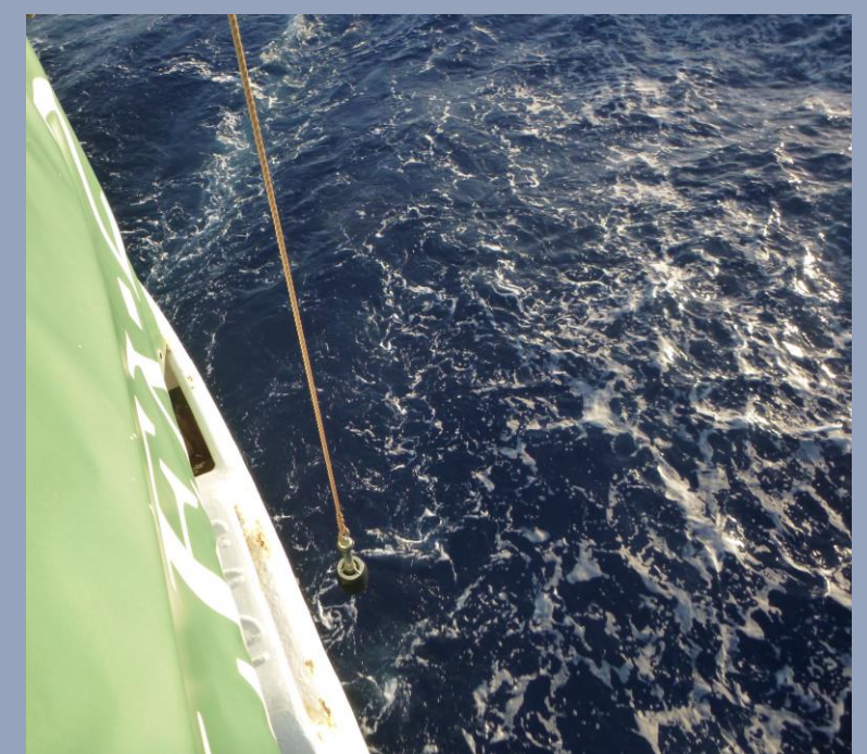
Abbildung 6: Messen der Oberflächenwassertemperatur
