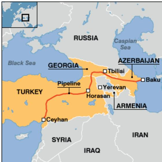
Abb. 26. Verlauf der BTC-Pipeline
