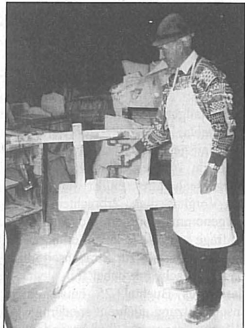
Abb. 14: Bohrmaschine für Zwicktaschen
