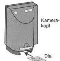
Zu Beginn vergewissern Sie sich, dass sich kein Objekt auf der Arbeitsfläche befindet (sehr wichtig). Legen Sie anschliessend das Dia in die Halterung. Die Kamera erkennt und fokussiert das Dia automatisch
