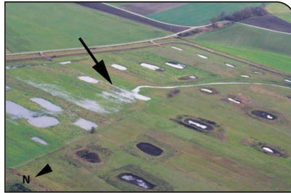
Abb. 2/3: Einleitung des Entwässerungsgrabens durch eine künstliche Rinne in den Überflutungsbereich (Pfeil).
