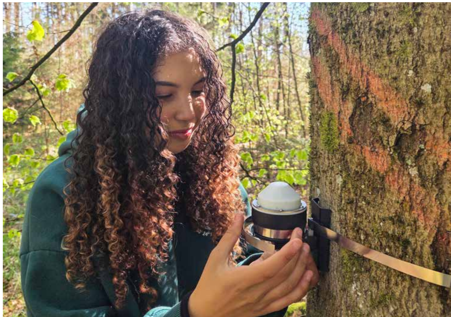
Caroline Werner, studentische Hilfskraft im Projekt REPHASE, installiert ein Dendrometer.
