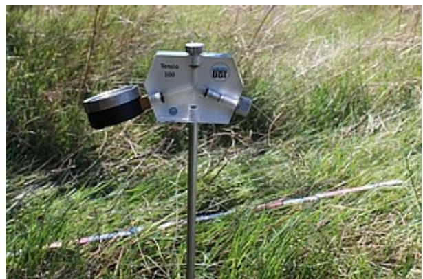
Tensiometer zur Messung der Bodenfeuchte
